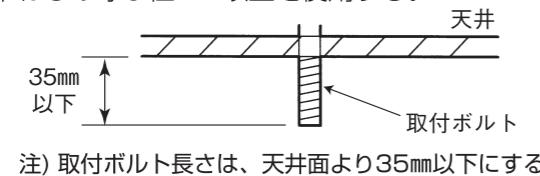
注) 取付ボルト長さは、天井面より35mm以下にする。
